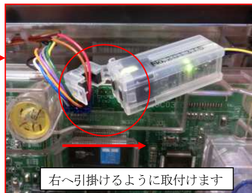
*コネクタの(赤、茶)の配線を写真の通り、本体の電源ランプを手前にして、CTセンサーランプ部を右へ引掛けるように取り付けます。
