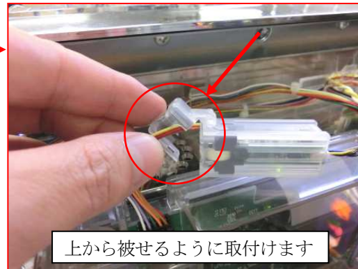
*コネクタの(橙、茶、赤、黄)の配線を写真の通り、CTセンサーランプ部を上から被せるように取り付けます。
