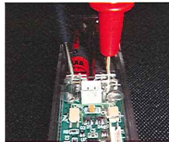
電池の消耗はテスターで確認できます。 DC2.3V以下が交換の目安です。
